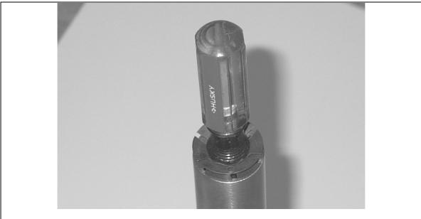
STEP 2. POSITION THE SHAFT OF A PHILLIPS SCREW DRIVER, THROUGH THE CENTER OF THE TUBE CONNECTOR AS SHOWN.
