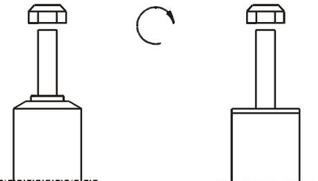
Zum Lösen und Anziehen der Muttern darf kein Schlag-schraubendreher verwendet werden, das Befestigungs-gewinde wird sonst zerstört. Selbstsi-chernde Muttern dürfen nur **ein-mal verwendet** werden!
