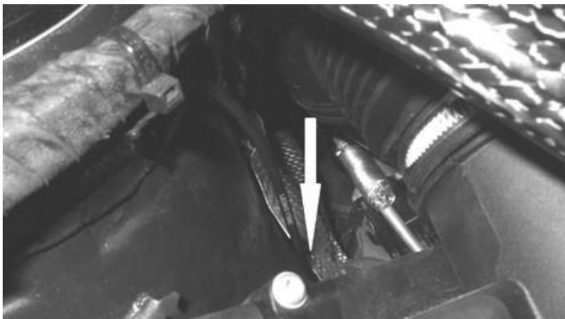
Das Kabel am Dom entlang nach oben führen./
