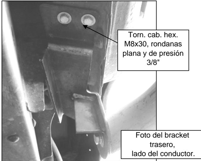
5. Monte el estribo a los brackets y fije con: (1) tornillo cab. hex 1/2", rondana plana y de presión 1/2" por cada bracket. No apriete aún.
